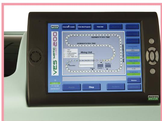
**Прослеживаемость пробы** — на экране отображаются все стадии измерения пробы от загрузки в модуль измерения, до выгрузки из прибора
